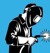
La **soudure TIG** a été inventée dans les années 1940. Elle utilise une petite électrode en tungstène et un gaz spécial pour protéger le métal de l'air pendant le travail. Cette technique permet d'assembler avec précision des pièces d'aluminium de formes différentes, sans les abîmer. Elle ne sera utilisée pour les cadres de vélos qu'à partir des années 1980.
