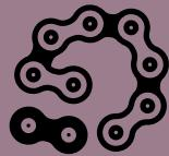
Vers 1880-1885, les progrès de la métallurgie permettent de fabriquer des pièces précises et solides. On invente alors la **chaîne articulée**, composée de maillons métalliques, qui transmet le mouvement des pédales à la roue arrière, rendant le vélo plus rapide et stable.
