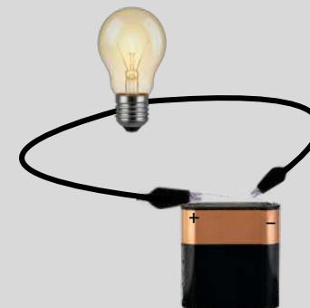
MONTAGE ÉLECTRIQUE EN CIRCUIT FERMÉ
