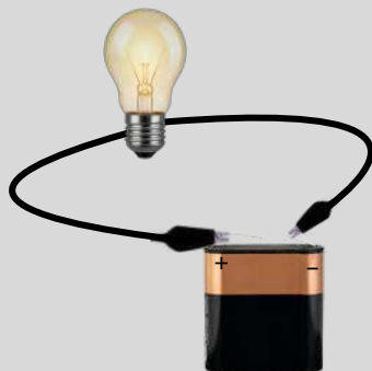
MONTAGE ÉLECTRIQUE EN CIRCUIT FERMÉ
