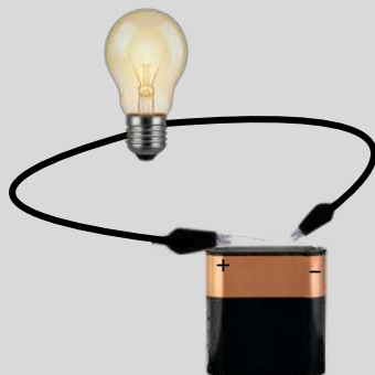
MONTAGE ÉLECTRIQUE EN CIRCUIT FERMÉ
