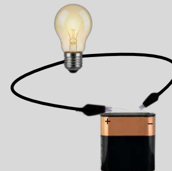
MONTAGE ÉLECTRIQUE EN CIRCUIT FERMÉ
