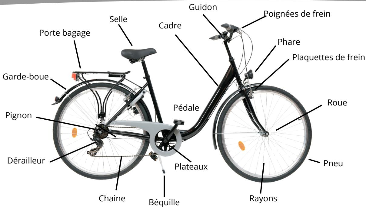
Le vélo est un objet technique inventé par les êtres humains pour répondre à un besoin : se déplacer. Il est constitué d'un assemblage de pièces qui permettent d'avancer grâce à la force des jambes, de freiner pour ralentir ou s'arrêter, d'adapter l'effort selon le terrain, de garder l'équilibre et se diriger,, d'assurer le confort et la sécurité.
